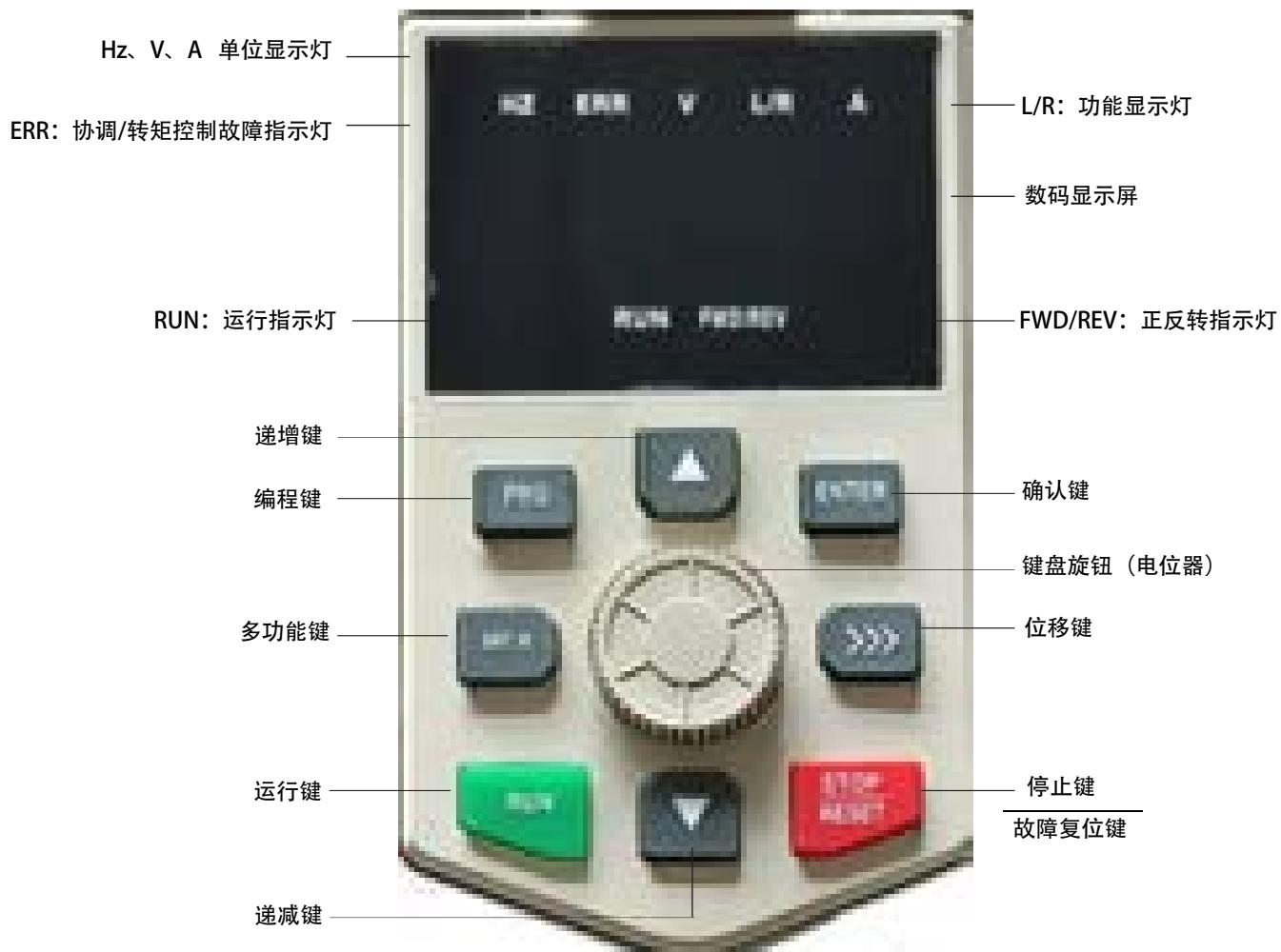
图 4-1 操作面板示意图
